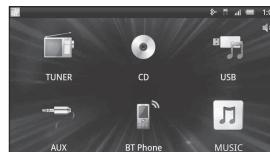
Para seleccionar otra fuente o aplicación, presione SRC y, a continuación, gire el selector de control para seleccionar la fuente o aplicación deseados.
